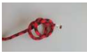
Foto 1: Doppelter Spierenstich/doppelter Überhandknoten zur Absicherung eines Achterknotens
